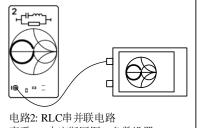
电路2: RLC串并联电路 查看S11史密斯圆图,参数设置: 起始频率=50kHz.终止频率=600MHz
